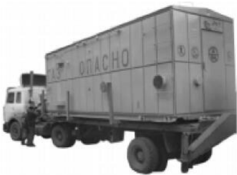
Пункт газорегуляторный блочный ПГБ-150, ПГБ-150-СГ*, ПГБ-150-СГ-ЭК** «Голубое пламя»
